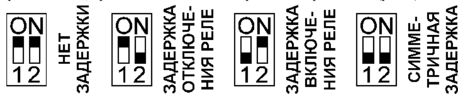
Рис. 4. Внутренние переключатели датчика РДД-02А.
